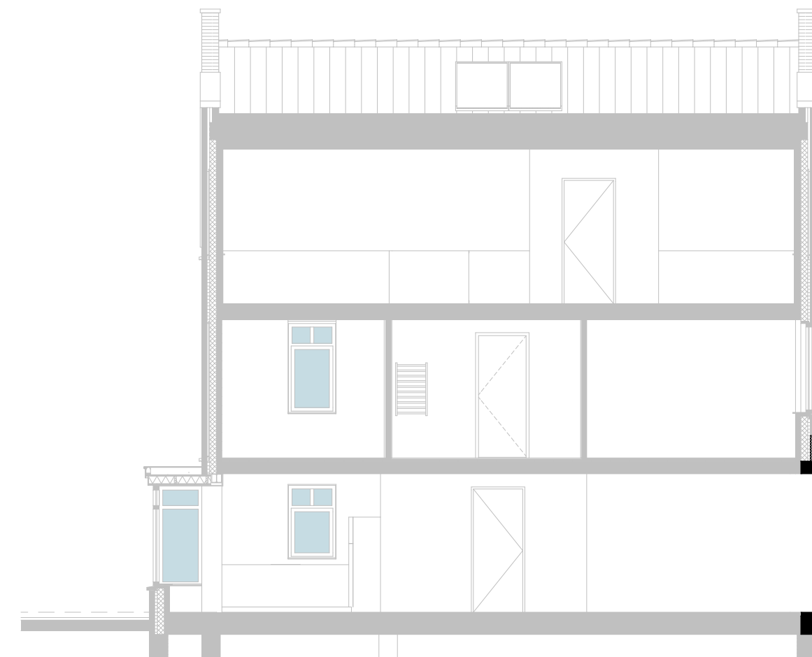
Doorsnede uitbouw 1,2m
